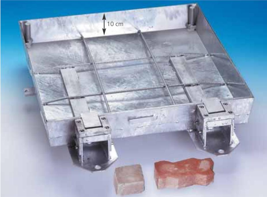
**Belastung:** 125 kN Prüfkraft (EN 124), bei mind. 5 cm Betonstärke der Güte C35/45 (EN 206) (Siehe auch Seite 3 und 29).
