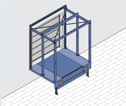
**Vorsatzschleuse LHF 2 zur bauseitigen Beplankung**
